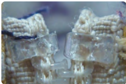
上止に傷がついてしまった例。バリ状となり危険です。
