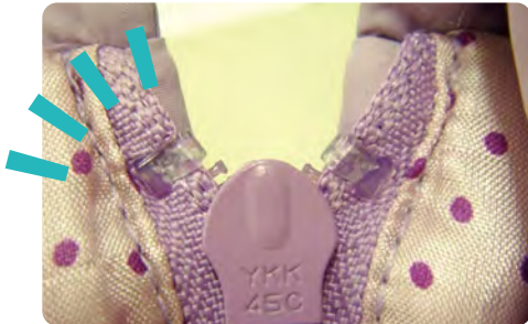
縫製位置がギリギリすぎる取り付け例。
