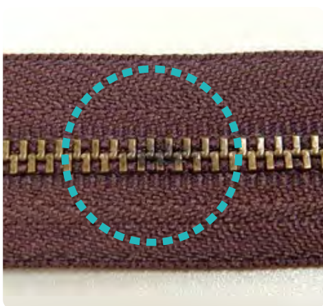
金属エレメントの腐食
